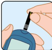
センサーを測定器に差し込むと、自動的に電源が入ります。センサー容器のコード番号と、測定器に表示されたコード番号が一致していることを確認します。
