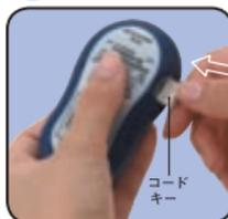
電源が切れていることを確認して、コードキー差込口に奥までしっかりと差し込んでください。前回使用していた試験紙コードキーが差し込んでいる場合は、外して捨ててください。
